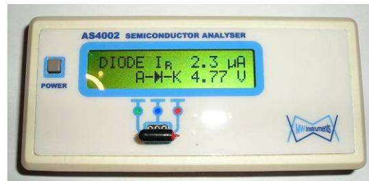
Diode OA90 (Germanium), repérage automatique de l'anode et de la cathode et mesure du courant dans le sens inverse, ici  $I_r = 2,3 \mu\text{A}$  pour  $U_r = 4,77 \text{ V}$
