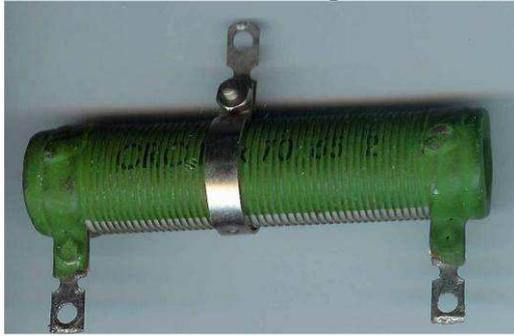
Résistance bobinée de puissance ajustable avec une bague de réglage (point de contact en dessous) pour l'obtention d'une valeur intermédiaire
