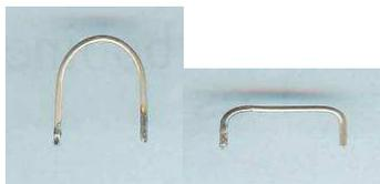
Bobine à 3/4 spire (épingle à cheveux) et une ligne de fil de cuivre argenté (traité contre l'oxydation) destinée aux très hautes fréquences,
