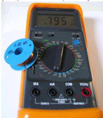
Pont de mesure RLC basses fréquences
