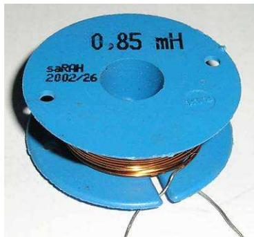
Bobine à spires jointives à plusieurs couches de fil de cuivre émaillé destinée aux basses fréquences et utilisée pour construire des filtres d'enceintes acoustiques Hi-fi
