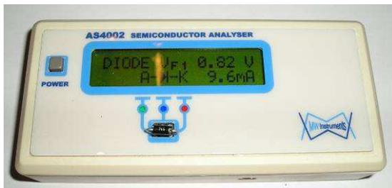
Diode 1N4004 (silicium), repérage automatique de l'anode et de la cathode et mesure du courant dans le sens direct, ici  $U_d = V_{fl} = 0,82 \text{ V}$  pour  $I = 9,6 \text{ mA}$  puis mesure dans le sens inverse et à différentes tensions.
