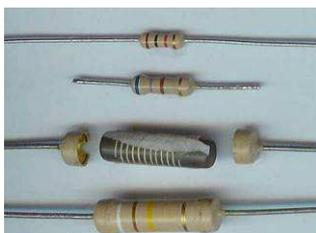
La résistance à couche de carbone est constituée d'une très fine couche de carbone déposée sur un barreau isolant en céramique et recouverte d'une couche de vernis. La valeur est ajustée en creusant la couche de carbone en forme hélicoïdale (voir ci-contre). Elle existe soit avec deux bagues de connexion fixées aux extrémités soit sans bagues de connexion, les connexions étant soudées directement aux extrémités (plus fiable mais plus fragile).
